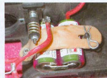
Voici un moyen simple et efficace pour fixer ses accus au châssis ! Un simple morceau de caoutchouc suffit !
