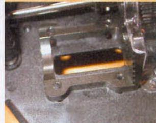
L'importateur MCM disposait d'un stand lors de ce championnat d'Europe. Ainsi, on a pu apercevoir un Mini Inferno Kyosho bardé d'options, telles que culasse moteur en aluminium, platine radio et supports d'amortisseurs en carbone ou encore un support moteur en alu usiné. Notons au passage que des noix de cardans en alu, des triangles supérieurs avant en alu, et des cardans articulés sont également disponibles.
