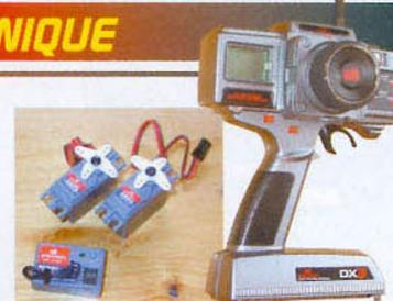
Encore chez MCM, Spectrum propose son propre émetteur, de type à volant. Celle-ci est livrée avec deux servos, un de type standard et l'autre possédant un couple plus important.
